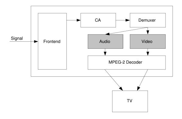
Abbildung 2.1.: Aufbau eines DVB-Empfängers
