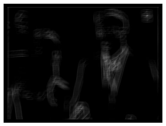
Abbildung 4.4.: Ergebnis nach Anwendung des Template Matching auf Kantenbild 4.2(b) mit Schablone 4.3(b). In der oberen rechten Ecke ist ein deutliches Maximum mit einer Helligkeit von 220 entstanden.
