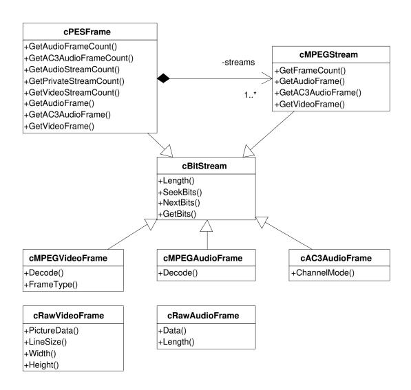
Abbildung 5.5.: Klassen für das Demultiplexen und Dekodieren und deren wichtigste Methoden
