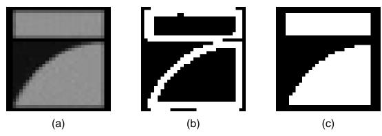
Abbildung 4.3.: Helligkeitskomponente (a) des Logos von Pro7 mit zugehöriger Schablone (b) und Maske (c)
