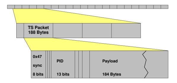
Abbildung 2.2.: Aufbau eines Transport Stream
