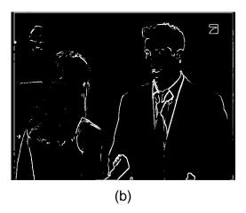
Abbildung 4.2.: Helligkeitskomponente eines Fernsehbildes (a) und Ergebnis nach der Kantendetektion mit Schwellwertrechnung (b)
