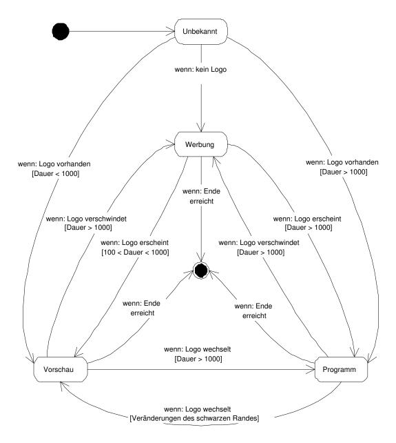
Abbildung 5.7.: Mögliche Zustände und wesentliche Übergänge bei der Analyse ohne Berücksichtigung von Spezialfällen
