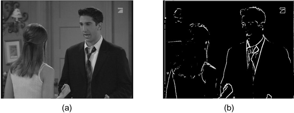
Abbildung 4.2.: Helligkeitskomponente eines Fernsehbildes (a) und Ergebnis nach der Kantendetektion mit Schwellwertrechnung (b)
